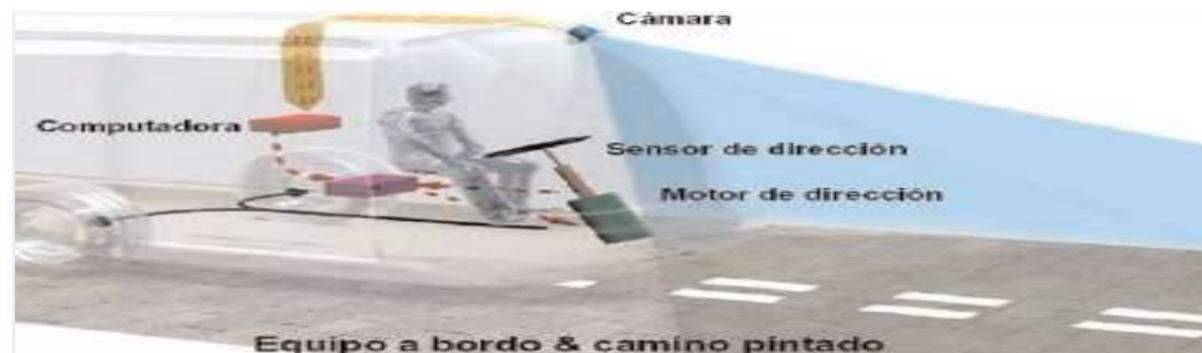
Sistema de guiado óptico para BRT
